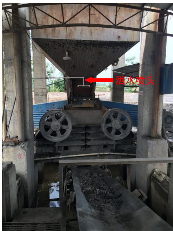
破碎工序自动洒水喷头
