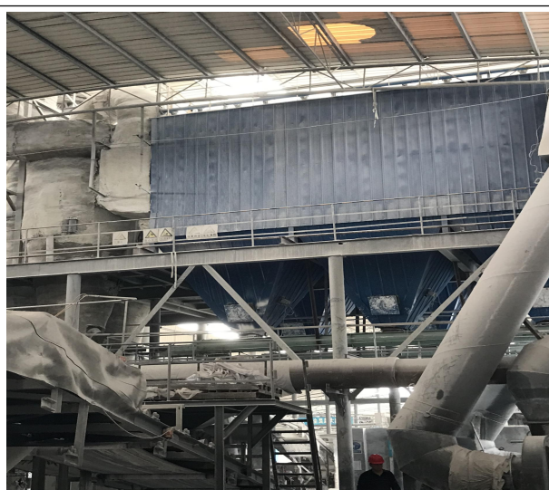
干燥系统废气处理设施 (旋风+布袋)
