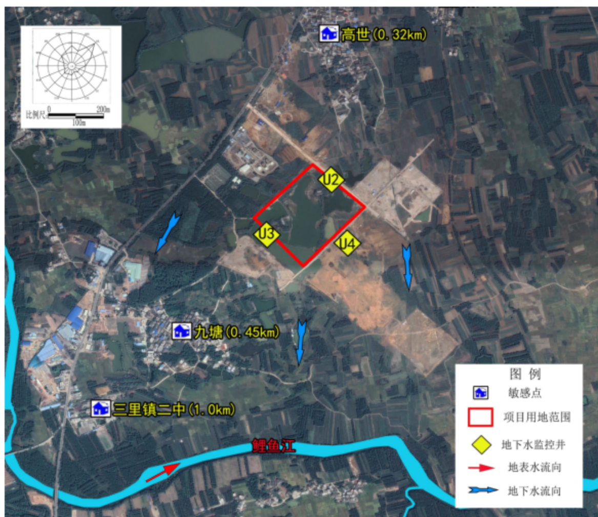
图 5.2.3-1 项目地下水跟踪监测点位置示意图
