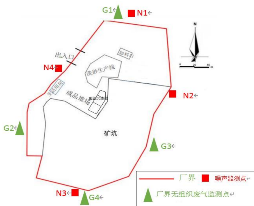
附图 3 项目废气、噪声监测布点示意图
